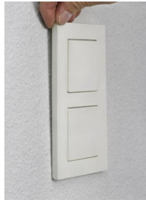
Die Wippen werden stets über den Rahmen vom Geräteinsatz abgezogen, d. h. der Rahmen wird am Rand von Hand oder mit einem kleinen Schraubendreher angehoben, wodurch die Wippe aus Ihrer Befestigung gelöst wird.
